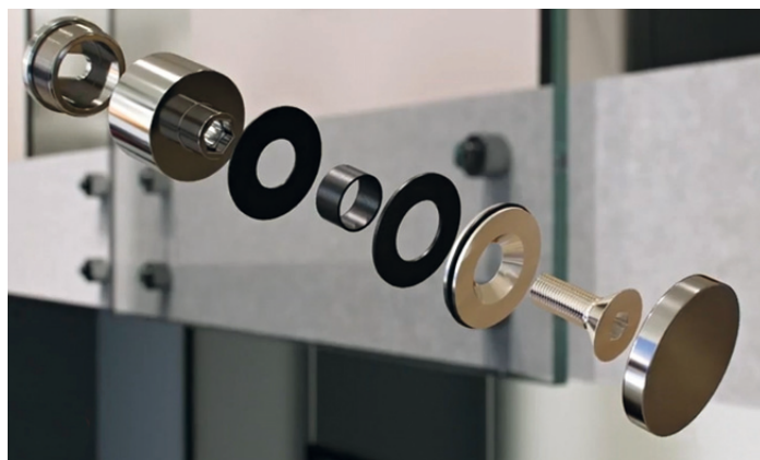
Plynulá regulace vzdálenosti od podkladu +5 mm je zabezpečena imbusovým klíčem přes otvor v tabuli skla a není nutné sklo snímat.
