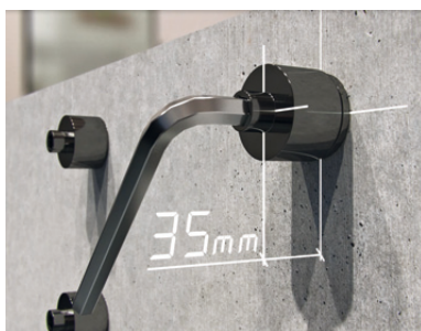
Plynulá regulace vzdálenosti od podkladu +5 mm je zabezpečena imbusovým klíčem přes otvor v tabuli skla a není nutné sklo snímat.
